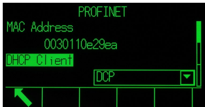
Abbildung 7-12: Anzeige der PROFINET MAC-Adresse des Terminals IND570
