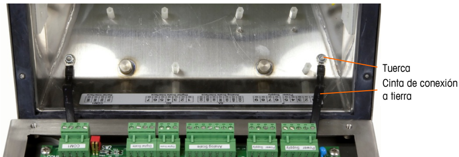
Figura 3-11: Para aflojar las cintas de conexión a tierra
