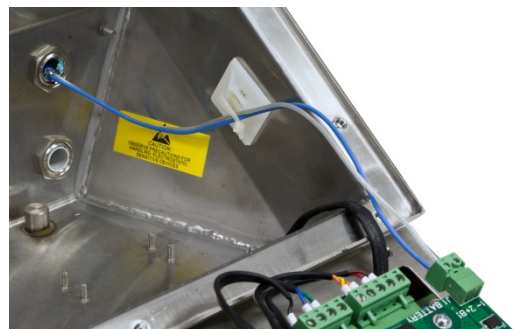
Abbildung 3-32: PAB-Akkupack-Verbinder (links) und Installation des Akkukabels
