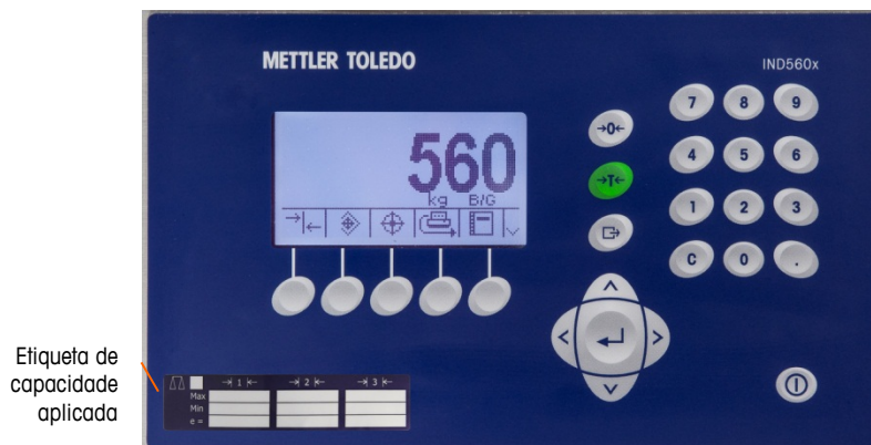
Figura 3-51: Etiqueta de capacidade instalada
