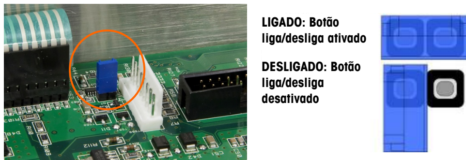
Figura 3-47: Jumper de desativação da tecla liga/desliga
