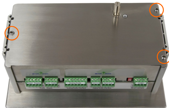
Abbildung 3-2: Öffnen des Gehäuses für den Schalttafeleinbau
