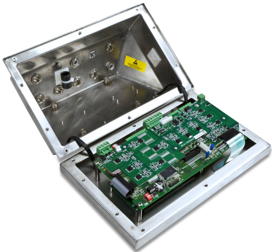
Figura 3-28: Placa Adaptadora de Alimentação instalada na placa principal do IND560x
