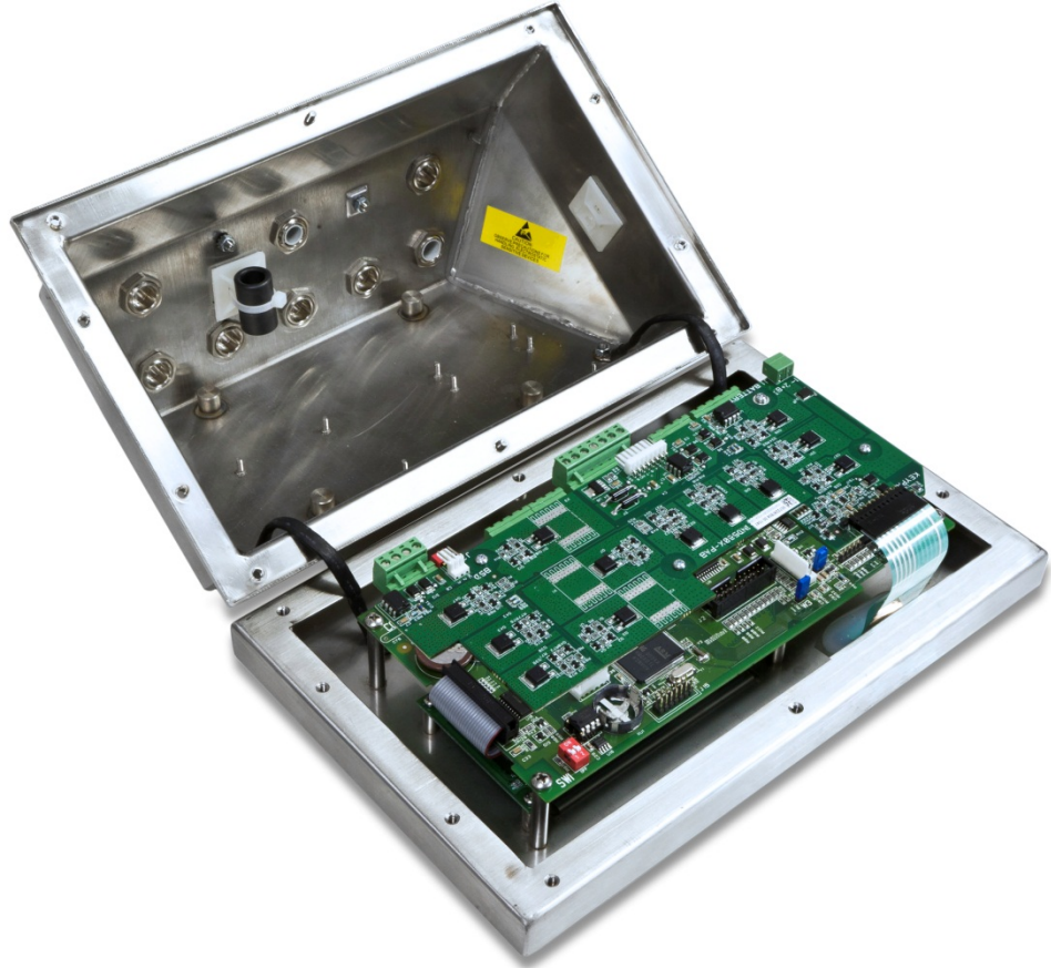
Figura 3-28: PAB installata sulla scheda madre del terminale IND560x
