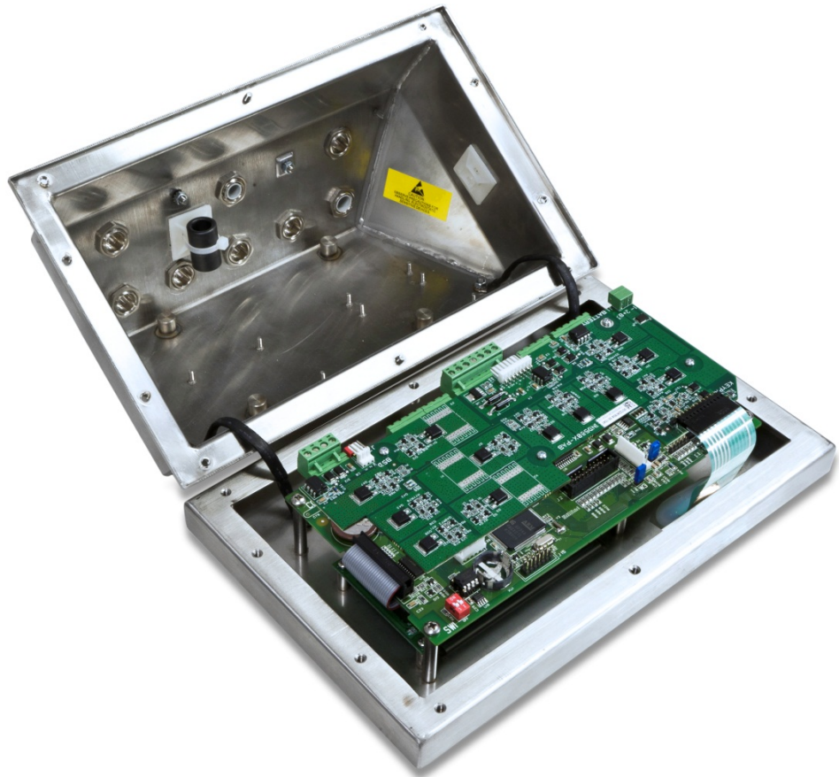
Abbildung 3-28: Stromadapterplatine (PAB) auf IND560x-Hauptplatine installiert
