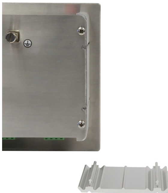
Figura 3-5: Retiro del soporte de retención
