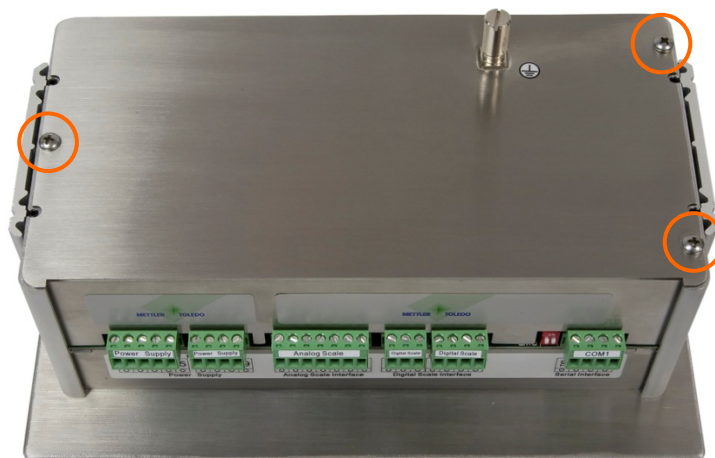
Figura 3-2: Abertura do gabinete para montagem em painel
