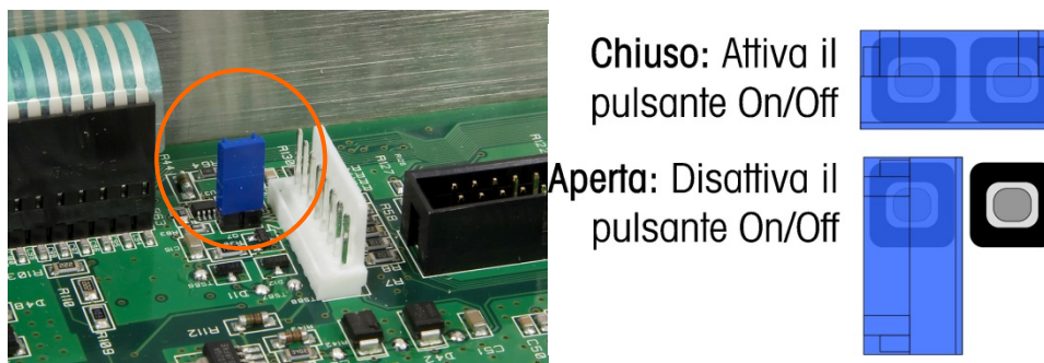
Figura 3-47: Disattivazione ponticello tasto On/Off
