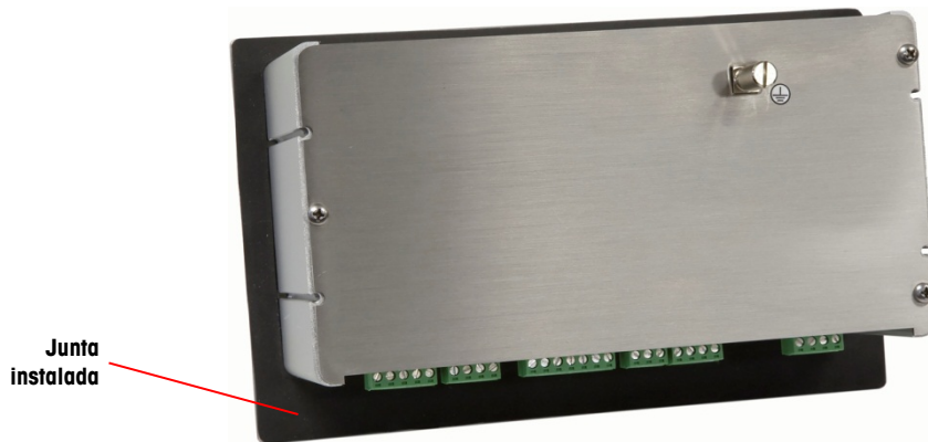
Figura 3-6: Junta del panel frontal instalada
