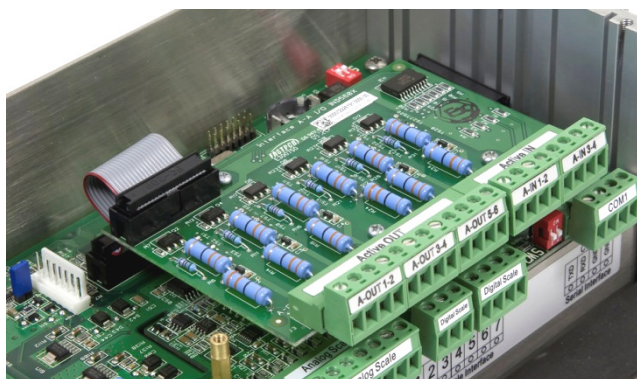
Figura 3-36: Instalación de E/S discontinuas en la caja para montaje en panel
