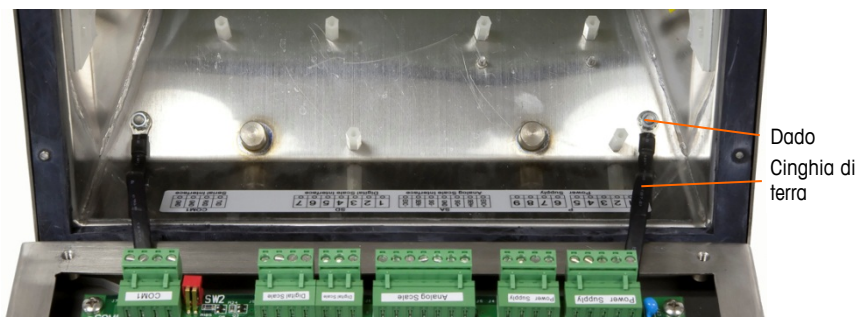
Figura 3-11: allentamento delle cinghie di terra
