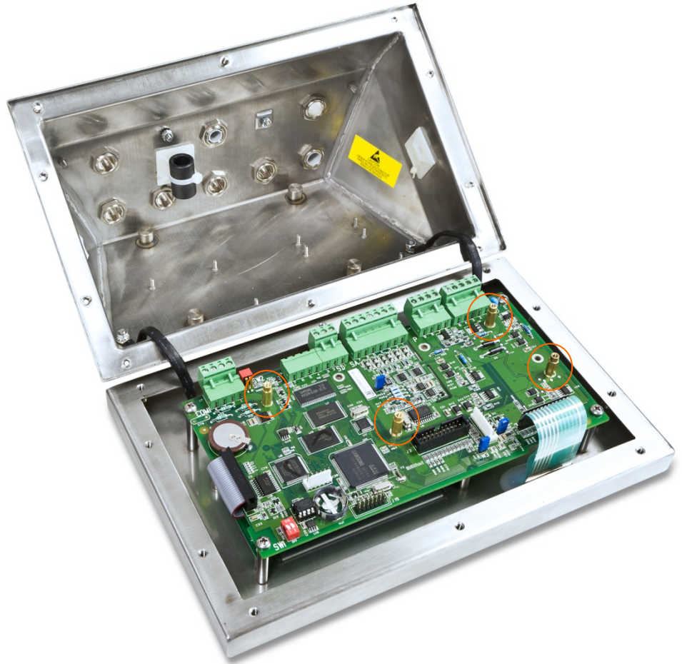
Figure 3-27 : Emplacement des supports en laiton de l'IND560x
