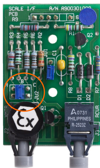
Figura 3-43: Ubicación de las patillas J2 en la PCB opcional del Puma/ID3sTx FO
