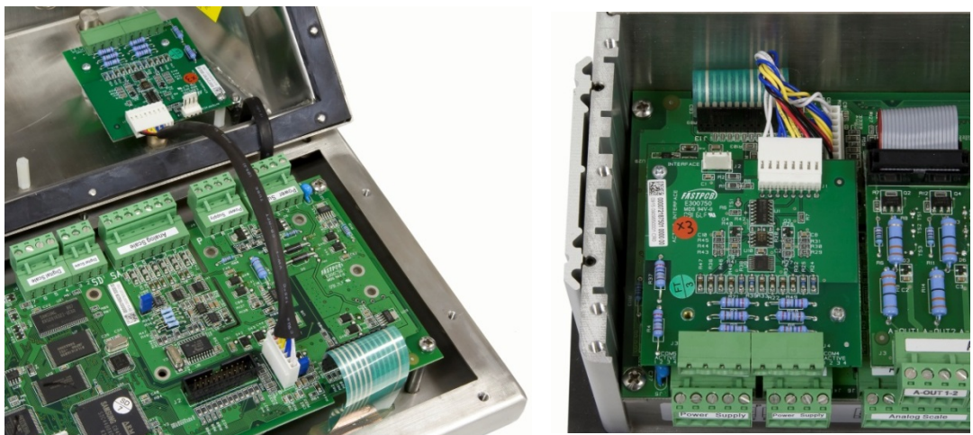
Figure 3-41: I.S. Carte d'interface CL – Installations pour environnement rude (gauche) et avec montage sur panneau (droite)
