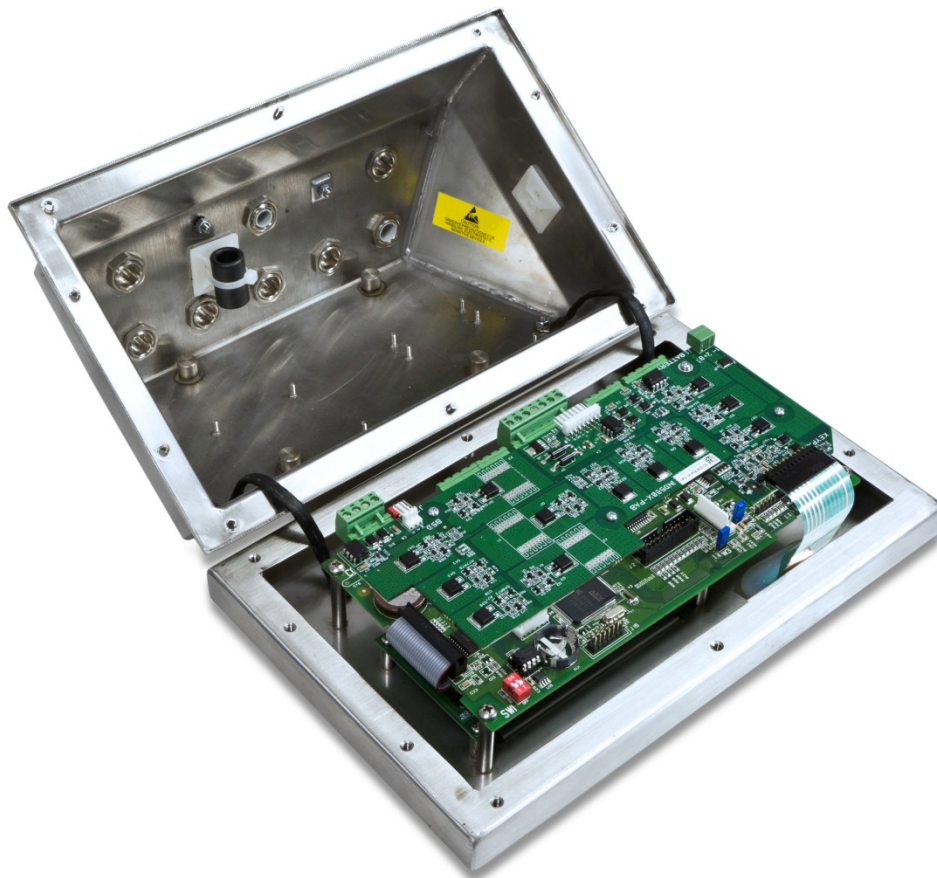
Figure 3-28 : PAB installé sur la carte principale d'un IND560x
