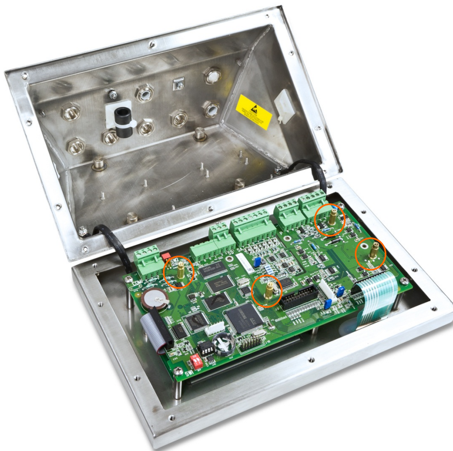
Figura 3-27: Posizionamento dei distanziatori in ottone dell'IND560x-PAB
