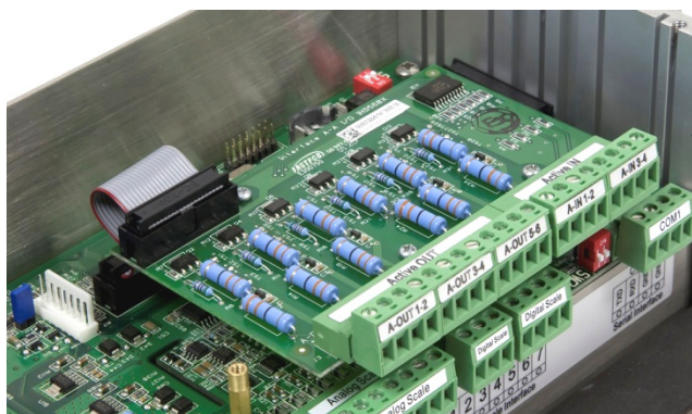
Figura 3-36: Installazione I/O discreto armadietto per montaggio a pannello
