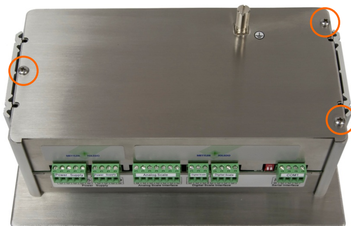
Figure 3-2: Ouverture de la version montage sur panneau
