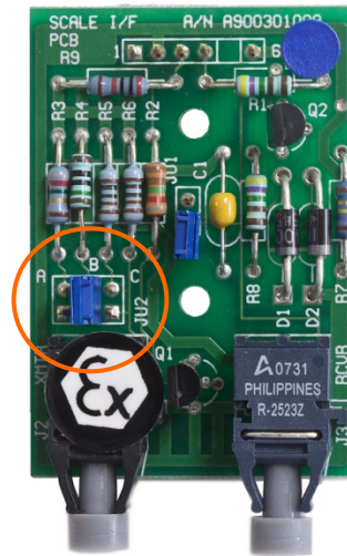
Abbildung 3-43: J2-Stiftposition auf der LWL-Optionsplatine des Puma/ID3sTx-Terminals
