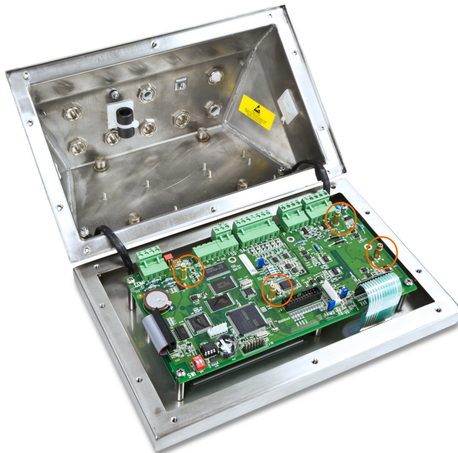
Figura 3-27: Localização dos apoios de latão da placa IND560x-PAB
