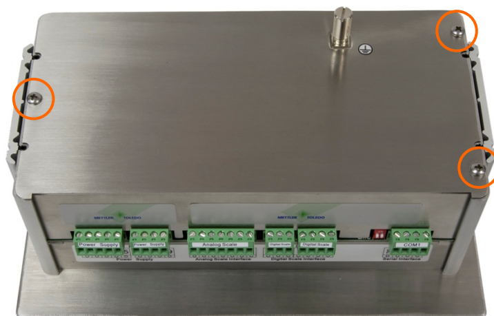
Figura 3-2: Apertura dell'involucro di montaggio a pannello
